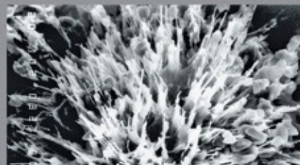
OČVRSNUT BETON (KRISTALIZACIJA ZAVRŠENA)
